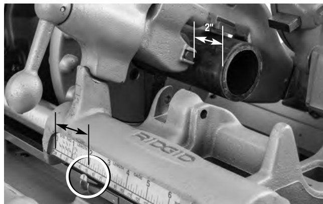
Figura 20 B – Puntero del calibrador de longitud en la longitud deseada
