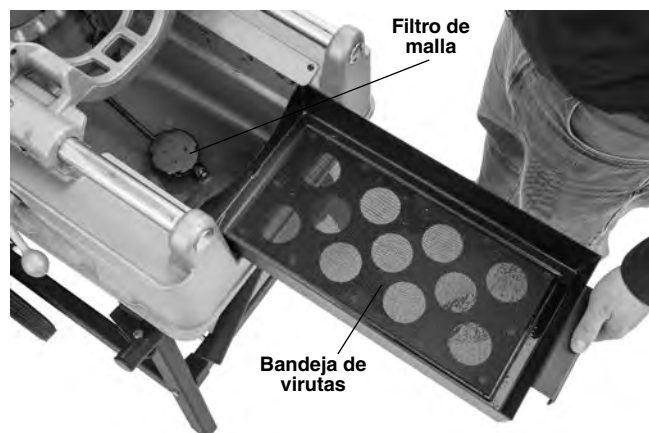
Figura 30 – Extracción de la bandeja de virutas
