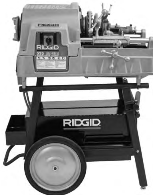
Figura 28 – Máquina preparada para su transporte
