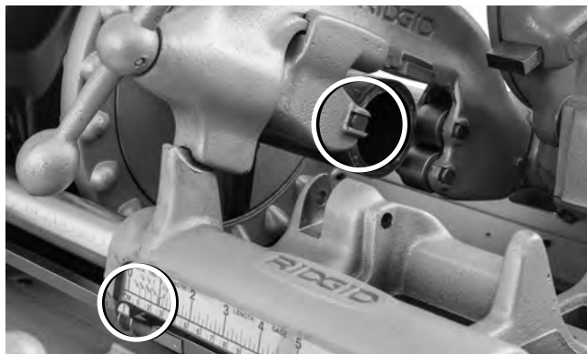
Figura 20 A – Filo de la rueda de corte contra el extremo del tubo. El puntero se coloca en cero (0).
