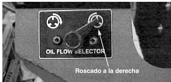
Figura 24 – Selección del flujo de aceite para roscar a la izquierda o a la derecha
