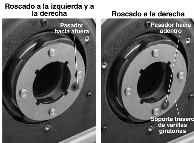
Figura 25 B – Soporte trasero de varillas giratorias y orientación del pasador
