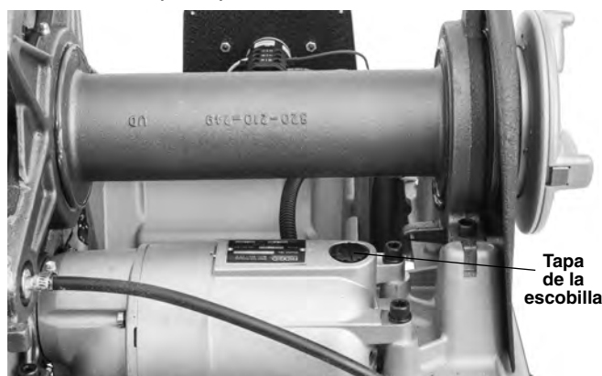
Figura 34 – Extracción de la tapa del motor para cambiar las escobillas
