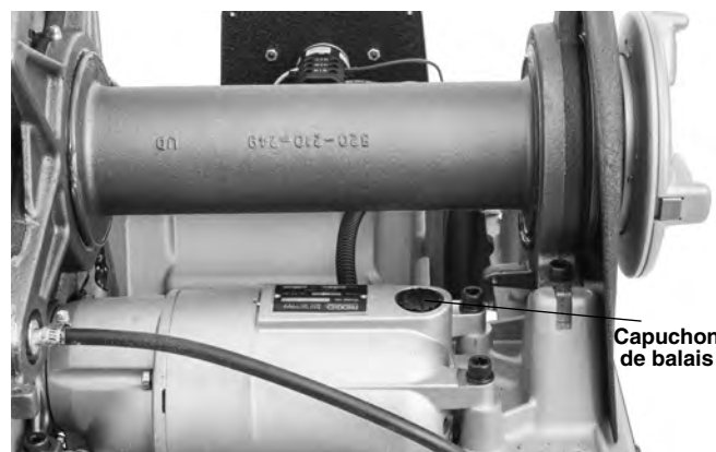
Figure 34 – Retrait du capot et remplacement des balais
